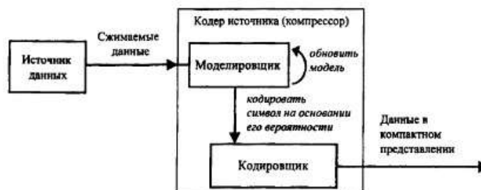
Рис. 2. Обобщенная схема реализации адаптивного энтропийного кодера
