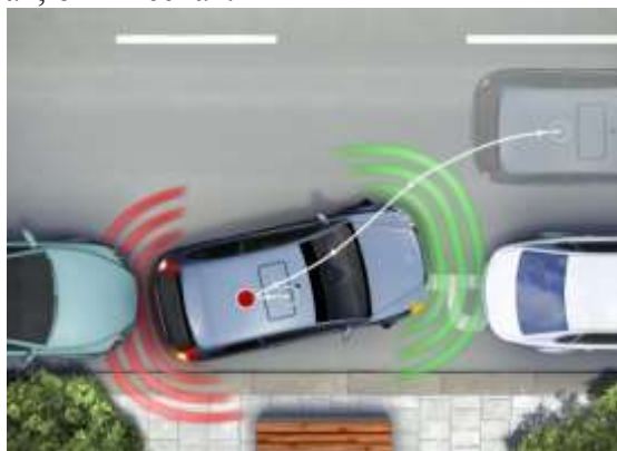
Рис.2 Принцип работы парковочной системы
